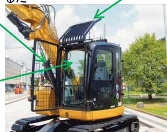
運転室周りの飛来物防護設備の例
